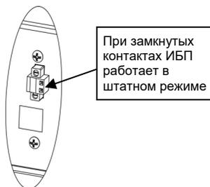
Рисунок 13 – Внешний вид порта дистанционного аварийного отключения (ЕРО), расположенного на задней панели ИБП
